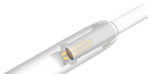
Figura 2. Esquema ilustrativo do encaixe do bastão de tabaco no sistema de aquecimento para os primeiros dispositivos iQOS
