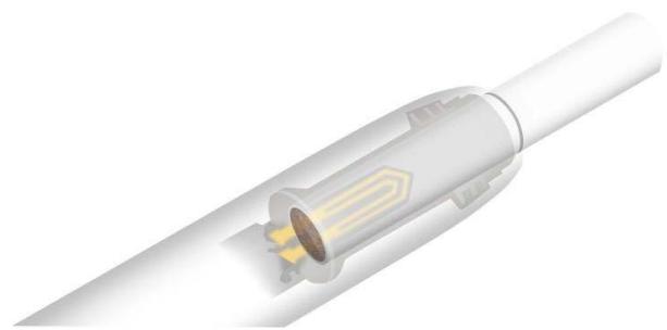
Figura 2. Esquema ilustrativo del encaje de la varilla de tabaco en el sistema de calentamiento para los primeros dispositivos IQOS Fuente: Wikipedia 30 .
