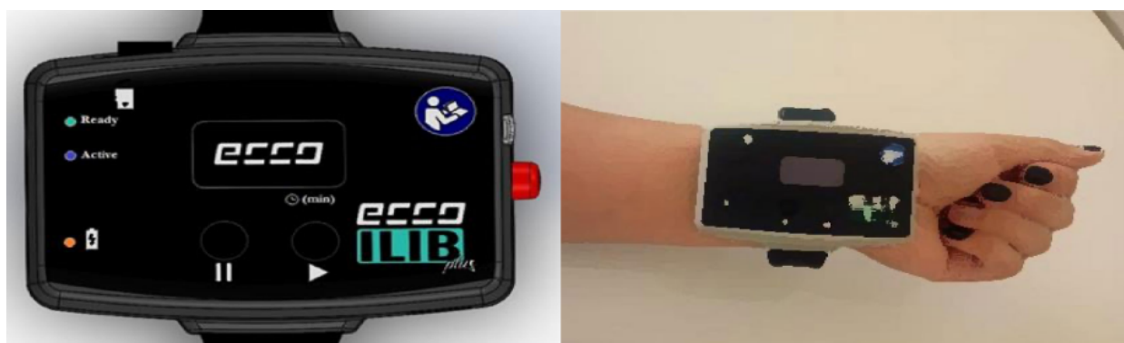
Figura 1. Equipamento Ecco ILIB Plus e sua aplicação na artéria radial esquerda
